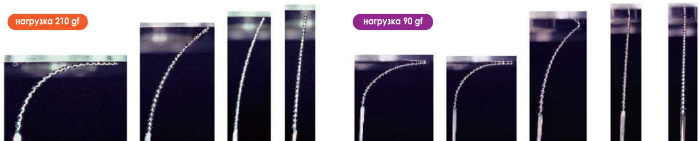
Рис. 3 Различия в гибкости в зависимости от формы поперечного сечения при нагрузке 210 gf или 90 gf на ось файла N 40. Гибкость файла увеличивается при уменьшении диаметра центральной части.
