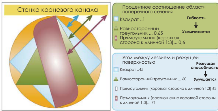
Рис. 1 Форма поперечного сечения и процентное изменение в размере области поперечного сечения и угла между лезвием и режущей поверхностью. Область поперечного сечения (если диаметр круга = 2r):
